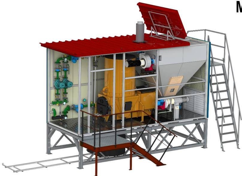
Загрузка топлива осуществляется через люк в крыше модуля, с помощью ковшового конвейера, автопогрузчика или бортовой крана. Одна загрузка обеспечивает автономную работу котельной несколько дней.
